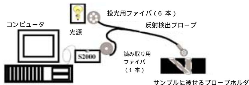
反射率測定の一般的な装置構成
